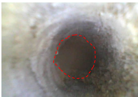
Figure 13: aperçu de l'homogénéité des matériaux et de la face opposée du mur à 15 centimètres avec un vide juste à l'arrière
