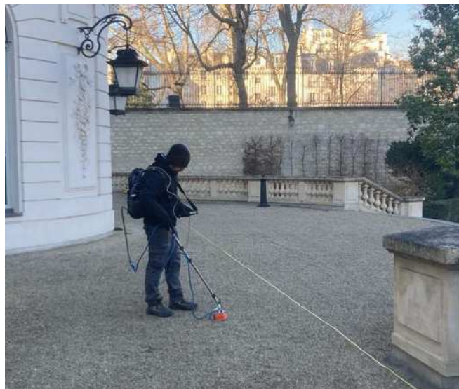
Figure 4 : Illustration de la mise en œuvre du radar (antenne 2GHz)
