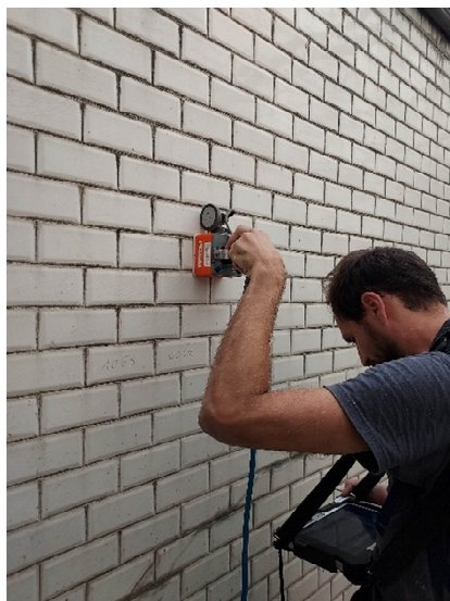
Figure 3 : Illustration de la mise en œuvre du radar (antenne 2GHz)
