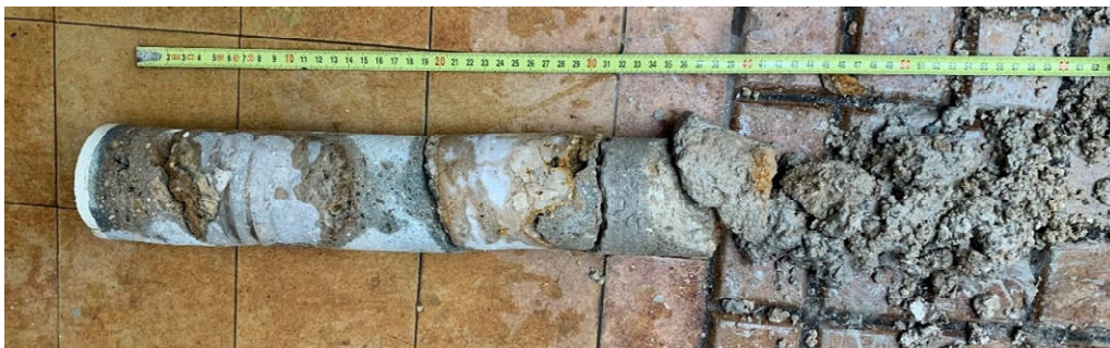
Figure 23: aperçu des matériaux constituant le mur de soutènement M-04
