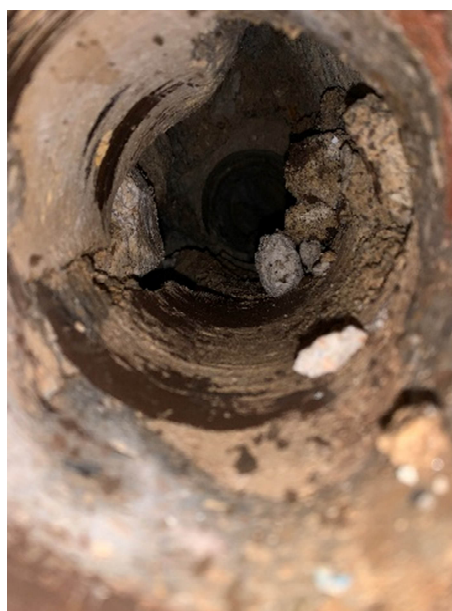
Figure 28: aperçu des vides et de la décohéson des matériaux à l'intérieur du carottage
